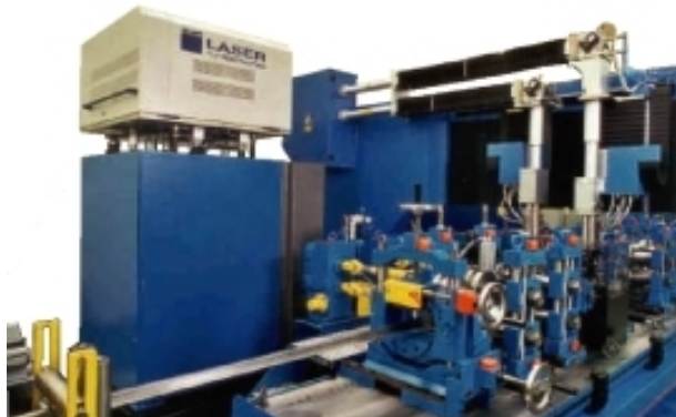
Slika 3. Linija za izradu profila i cijevi iz krojenih limova
