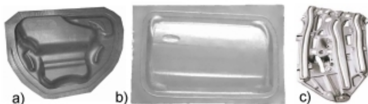
Slika 10. Dijelovi proizvedeni tlakom tekućine; a) spremnik goriva, b) faza u proizvodnji vanjskog dijela vrata, c) ogledni dio za demonstraciju mogućnosti AHU tehnologije
