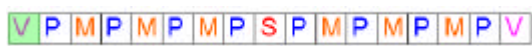
Slika 4. Redoslijed popravaka i pregleda jednog ciklusa održavanja; V-veliki popravak, P-pregled, M-mali popravak, S-srednji popravak
